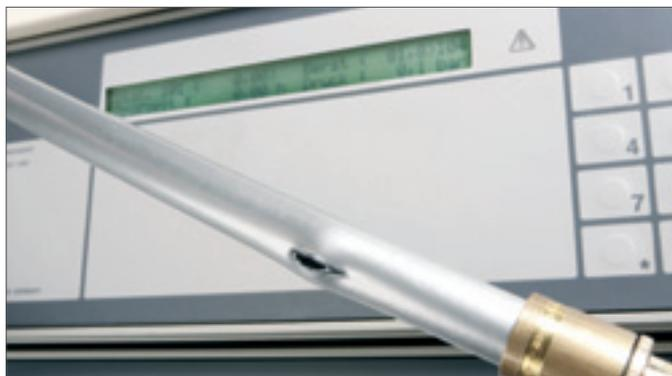
Рис. 4-5 Результаты испытания прочности на разрыв давлением. Испытуемый продукт – универсальная труба RAUTITAN flex
