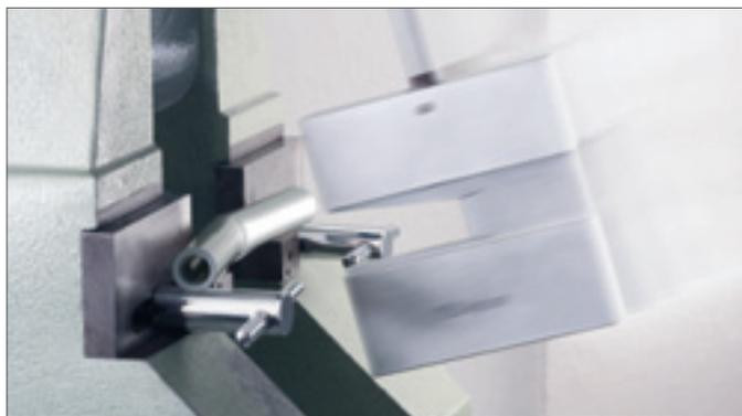
Рис. 4-6 Универсальная труба RAUTITAN flex в установке по испытанию ударной вязкости
