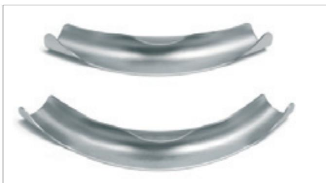
Рис. 13-4 Фиксаторы поворота (водоснабжение / отопление) (3-4 х Ø) – 90° или 45° для изгиба труб Ø 16-32
