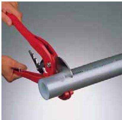
Рис. 47. Отрезать трубу по требуемому размеру
