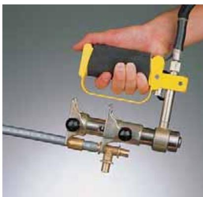
Рис. 43. Вставить соединение в запрессовочную насадку (тиски) без перекоса
