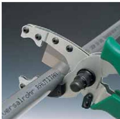
Рис. 31. Резка труб RAUTITAN stabil ножницами RAUTITAN 16/20 (арт. № 247 474 001)
