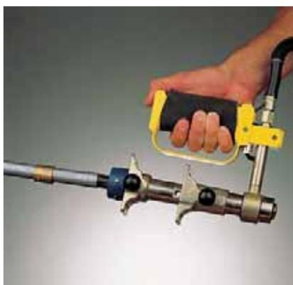
Рис. 40. **Расширительный инструмент 16/20.** Произвести развальцовку трубы в два приема, повернув трубу относительно расширительной насадки после первой развальцовки на 30°. Подвижная гильза не должна находиться в зоне развальцовки. Трубу и насадку не перекашивать друг относительно друга
