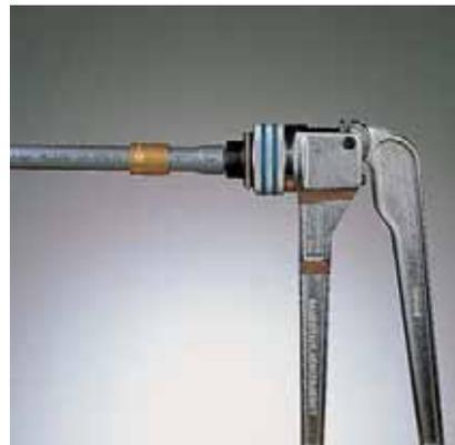
Рис. 39. **Расширительный инструмент RO.** Произвести развальцовку трубы в два приема, повернув трубу относительно расширительной насадки после первой развальцовки на 30°. Подвижная гильза не должна находиться в зоне развальцовки. Трубу и насадку не перекашивать друг относительно друга
