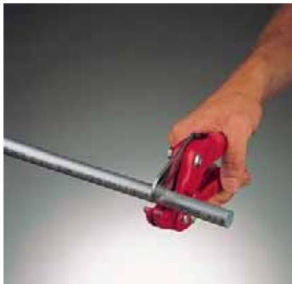
Рис. 37. Отрезать трубу по размеру под прямым углом
