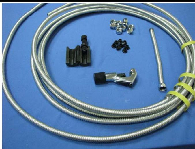
**Комплектующие для изготовления гибкой подводки:** труба нержавеющей в бухте, труборез, ручной вальцеватель, никелированные латунные гайки, резиновые прокладки.
