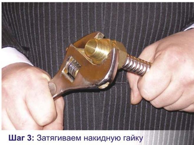
*Шаг 3: Затягиваем накидную гайку*
