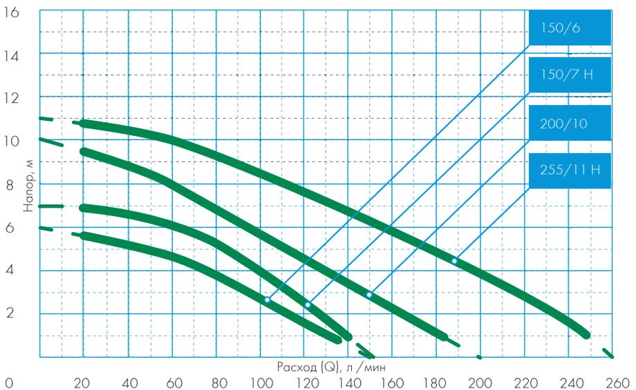
\* Заявленные характеристики насосов были получены при испытании с холодной чистой водой без газа и абразивных примесей, а также напорной магистралью согласно модели насоса и напряжением 220 вольт.
