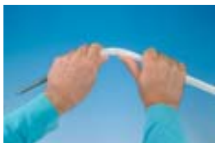
Изгиб при помощи внутренней спиральной пружины
