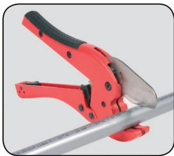
Отрезать трубу SANEXT «Универсальная» или «Стабил» под прямым углом ножницами, предназначенными для резки труб.
