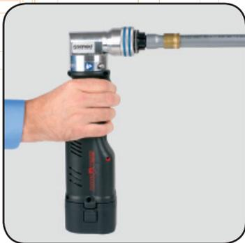
Вставить в трубу до упора ручной или аккумуляторный расширитель с расширительной насадкой требуемого диаметра. Равномерно свести рукоятки ручного расширителя или нажать пусковую кнопку аккумуляторного расширителя и удерживать ее нажатой до завершения расширения трубы. Расширение произвести за два цикла (труба при этом проворачивается вокруг своей оси на 30°)
