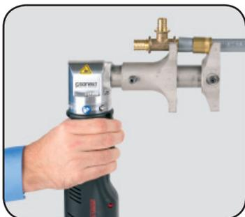
Запрессовать гильзу на фитинг с помощью ручного, гидравлического или аккумуляторного пресса с соответствующими диаметру трубы пресс-насадками.
