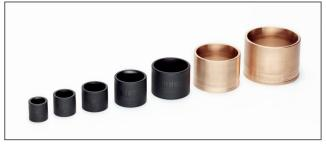
С фитингами RAUTITAN PX, MX, RX и SX Dy 16-40 мм применяются полимерные надвижные гильзы, изготовленные из PVDF (поливинилденфторид) и демонстрирующие столь же высокие прочностные и гигиенические показатели. Латунные надвижные гильзы используются только с фитингами RAUTITAN MX Dy 50-63 мм.
